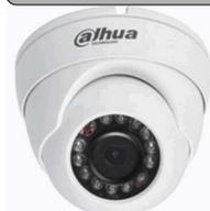
Telecamera Dome 2 Megapixel **Real-Time Full-HD** IP67 antivandalo IK10 con Day/Night meccanico, WDR 120dB, ottica fissa 3,6mm autofocus ed illuminatore IR con portata fino a 30 metri. Sensore CMOS 1/2,7" a scansione progressiva, sensibilità 0,01 Lux. La telecamera gestisce contemporaneamente 3 differenti flussi video personalizzabili. **La risoluzione massima supportata è pari a 1920x1080 pixel con frame rate massimo di 25 fps.**
