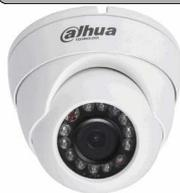
Telecamera dome 1 Megapixel IP66 con Day/Night meccanico, ottica integrata di tipo fisso 3,6mm ed illuminatore smart IR con portata massima pari a 20 metri. Sensore CMOS 1/2,8" Sony Exmor a scansione progressiva, sensibilità 0,01 Lux. **La telecamera fornisce uscita video in standard HD-CVI con risoluzione HD 1280x720 pixel a 50fps.** La configurazione avviene tramite menu OSD accessibile su cavo coassiale direttamente dal DVR.
