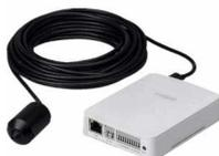
Telecamera da interno con gruppo ottico remoto 1,3 Megapixel. Day/Night elettronico, ottica integrata 3,6 mm tipo pinhole. Sensore CMOS 1/3" Aptina a scansione progressiva, sensibilità 0,01 Lux.
