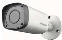
Telecamera bullet 1 Megapixel IP66 con Day/Night meccanico, ottica integrata di tipo varifocale motorizzata 2,7~12mm autofocus ed illuminatore smart IR con portata massima pari a 30 metri. Sensore CMOS 1/3" Aptina a scansione progressiva, sensibilità 0,002 Lux. **La telecamera fornisce uscita video in standard HD-CVI con risoluzione HD 1280x720 pixel a 25fps.** La configurazione avviene tramite menu OSD accessibile su cavo coassiale direttamente dal DVR.
