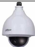
Telecamera Speed Dome 2 Megapixel IP66 con Day/Night meccanico. Zoom 12X ottico (5,1~61,2 mm) autofocus, rotazione orizzontale 360° continua (max. 300°/sec.). Sensore CMOS 1/3" Sony Exmor a scansione progressiva, sensibilità 0,05 Lux. **La telecamera fornisce uscita video in standard HD-CVI con risoluzione Full-HD 1920x1080 pixel a 25fps. Il menu OSD ed i comandi per il brandeggio della telecamera viaggiano su cavo coassiale e possono essere eseguiti direttamente dal DVR.**
