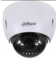
Telecamera Speed Dome 1 Megapixel IP66 con Day/Night meccanico. Zoom 12X ottico (5,1~61,2 mm) autofocus, rotazione orizzontale 360° continua (max. 160°/sec.). Sensore CMOS 1/3" Sony Exmor a scansione progressiva, sensibilità 0,01 Lux. **La telecamera fornisce uscita video in standard HD-CVI con risoluzione HD 1280x720 pixel a 50fps. Il menu OSD ed i comandi per il brandeggio della telecamera viaggiano su cavo coassiale e possono essere eseguiti direttamente dal DVR.**
