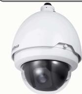
Telecamera Speed Dome 1 Megapixel IP66 termoventilata con Day/Night meccanico. Zoom 20X ottico (4,7~94 mm) autofocus, rotazione orizzontale 360° continua (max. 300°/sec.). Sensore CMOS 1/3" Sony Exmor a scansione progressiva, sensibilità 0,05 Lux. **La telecamera fornisce uscita video in standard HD-CVI con risoluzione HD 1280x720 pixel a 50fps. Il menu OSD ed i comandi per il brandeggio della telecamera viaggiano su cavo coassiale e possono essere eseguiti direttamente dal DVR.**
