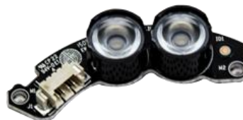
LED IR di 3° generazione, 2 Led portata 30 metri
